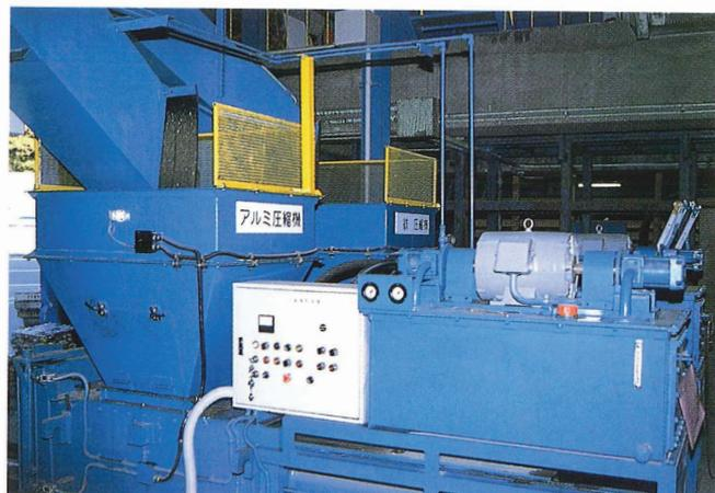
収集された缶を鉄とアルミに分けてプレスし、再生業者へ渡します。
